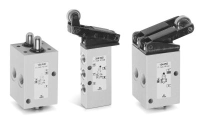
**1 和 3 系列机控阀**具有二位三通和二位 五通两种机能,有三种驱动方式:柱轴驱 动、滚珠杠杆驱动和单向滚珠杠杆驱动;复 位形式均为机械弹簧复位。
