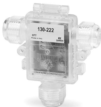
Le convertisseur électronique Série 130 permet de piloter n'importe quelle électrovanne proportionnelle avec un courant max. de 1 A. Il transforme un signal standard ( 0-10V ou 4-20 mA ) en un signal PWM pour obtenir en sortie de l'électrovanne une valeur proportionnelle au signal d'entrée.
