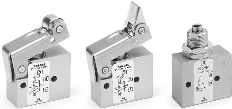
**2系列小型机控阀**为二位三通，具有常闭（NC）和常开（NO）机能，阀体上带有 M5 内螺纹接口或  $\varnothing 4$  快插接头。该系列机控阀有如下几种不同的驱动方式：柱轴驱动、滚珠杠杆驱动和单向杠杆驱动。
