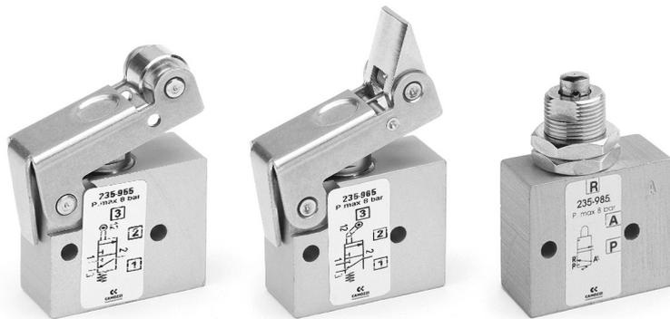
Les mini vannes à commande mécanique Série 2, 3/2 Normalement Ouvert sont disponibles avec orifices taraudés M5 ou avec cartouche instantanée pour tube Ø4. Les dispositifs sont à actionnement par plongeur, galet ou levier à galet escamotable.
