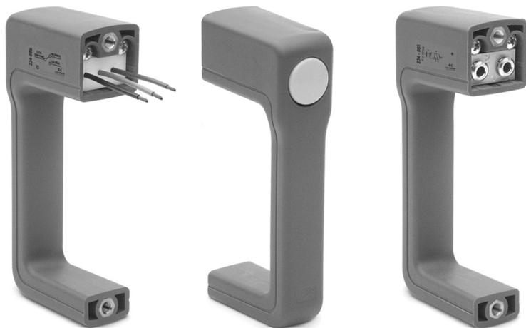
**2 系列小型手柄阀**有气、电两种形式。气控手柄阀，其内部带有一个微型二位三通手控阀，当用手握住手柄并用拇指按下手柄上的按钮时，内部的手控阀动作。电控手柄阀，其内部带有一个单触点微型转换开关，当用手握住手柄并用拇指按下手柄上的按钮时，内部的单触点微型转换开关动作。小型手柄阀可安装在各种形式的机座上，与气动系统或者电气系统连接后，组成手动气开关或手动电开关。
