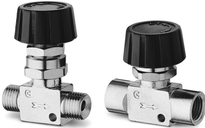
**28 系列流量控制阀**是一种双向流量控制阀，阀体由黄铜制成，表面镀镍，丁腈橡胶密封件和工程塑料旋钮。阀体进出接口为外螺纹或内螺纹，其螺纹规格有 G1/8, G1/4, G3/8 和 G1/2 四种，各具不同的公称流量。阀的连接管可采用尼龙管，也可以采用紫铜管。该系列阀适用于调节压缩空气、水或矿物油的流量。
