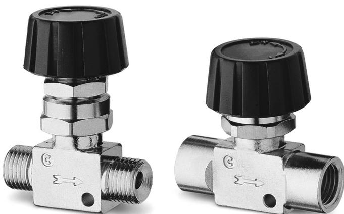
Sono valvole di regolazione bidirezionali costruite interamente in OT nichelato con guarnizioni in gomma NBR e volantino in tecnopolimero. Sono adatte alla regolazione di aria compressa, acqua e oli minerali.
