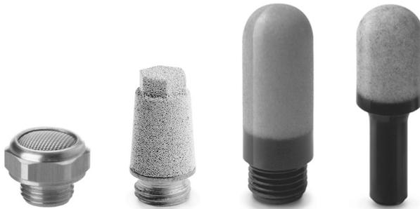
Schalldämpfer sind von einer pneumatischen Steuerung nicht wegzudenken. Austretende Druckluft befindet sich in turbulenter Strömung. Durch die Gestaltung der Schalldämpfer wird sie in einen möglichst laminaren Zustand versetzt. Bei Pflege und Instandhaltung empfiehlt es sich, die Elemente mit Benzin oder Petroleum auszuwaschen und in entgegengesetzter Richtung mit Druckluft auszublasen.
