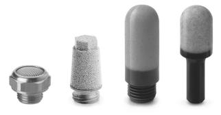
Los silenciadores son elementos indispensables para eliminar o atenuar el ruido característico del aire comprimido durante las fases de descarga. Sus conexión naturales esta siempre situado sobre descargas de las válvullas a 3/2, 5/2 o 5/3 viás. En fase de manutencion se conseja de desengrasar los silenciadores con gasolina or petróleo cuidando de soplar con aire comprimido en la dirección contraria a la de la utilización.
