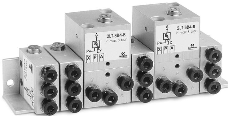
Las funciones lógicas de base de la serie "2L" han sido realizadas en 5 modelos diferentes y se pueden instalar separadamente gracias a los dos orificios pasantes en el cuerpo. La escuadra 2LQ - 8A permite el montaje en batería, ubicando las entradas y salidas frontalmente, facilitando el montaje de los tubos de conexión.
