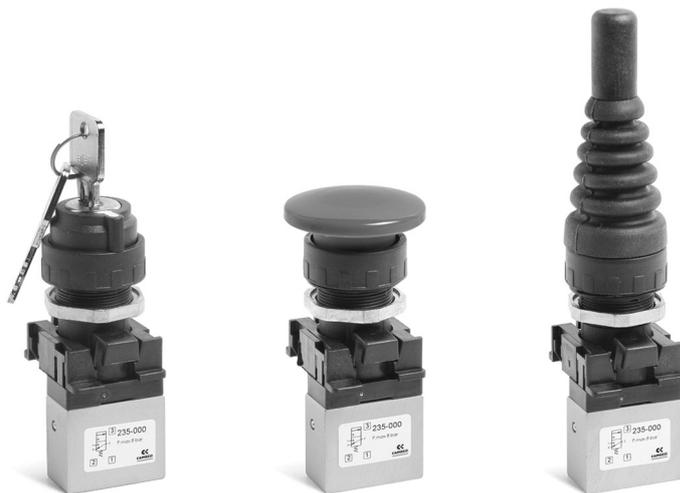
**2 系列小型手控阀**系面板式结构，可将此阀直接安装在操纵面板上，面板开孔直径为 22 mm。该系列手控阀是由各种形式的手控驱动头和二位三通基阀组装而成，具有很大灵活性。
