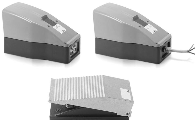
**3系列脚踏开关**有气、电二种形式。脚踏气开关中有一个二位五通机控阀，开关前端有 G1/4 接口可以安装管接头和消声器。如果将阀的其中一个出口用管接头堵住，该阀即可作为二位三通阀来使用。同时脚踏气开关可以任意选择单稳式或者双稳式，只需在脚踏开关上部打开红色保护片，拨动选择旋钮即可，如下页外形图中 (X) 部位局部放大图所示。
