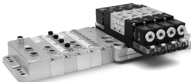
Die Serie 3 Plug-In Feldbus-Version wird mit einem Direktanschlussmodul an das Feldbus-Modul Serie CX mit PROFIBUS-DP, DeviceNet, CANopen, EtherNet/IP, EtherCAT, PROFINET angebaut. Analog zur Multipol-Version können max. 22 Magnetpulen/d.h. max. 22 Ventile monostabil gesteuert werden. Es steht ein breites Programm von elektrischen I/O-Modulen analog und digital zur Verfügung, für 0-10 V DC oder 4-20 mA.
