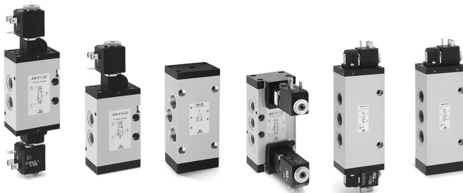
**4 系列电磁阀**是滑阀型电磁驱动先导式方向控制阀, 其单稳式电磁阀的复位形式有机械弹簧复位和气弹簧复位两种。
