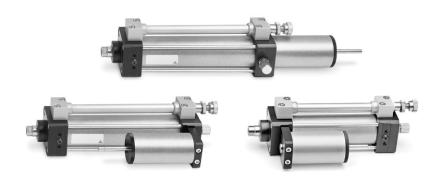
43 系列液压制动缸有个油缸,需与气缸共同使用,组成一个气-液阻尼气缸,以使气缸获得平稳的运动,比较广泛地用于进给驱动装置上。
