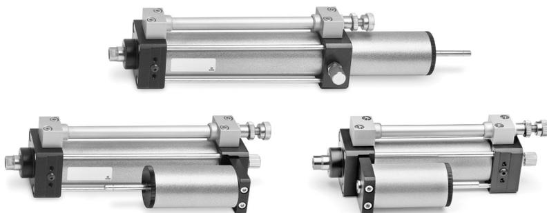
I freni idraulici Serie 43 sono disponibili con diverse possibilità di regolazione: uscita regolabile - rientro rapido e uscita rapida - rientro regolabile. Questi freni sono completi di serbatoio di compensazione olio che garantisce un ripristino automatico. La variazione delle velocità si ottiene attraverso un regolatore di flusso incorporato, concepito in modo tale da permettere un'utilizzazione molto ampia e costante.
