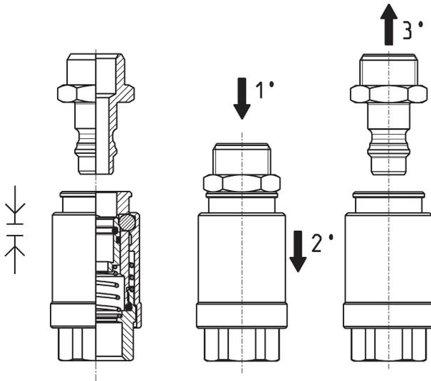
母接头的结构设计可保证接头连接时不发生意外的脱落。只有当用力按下公接头（如图示 1）和母接头螺母（如图示 2），母接头才会将公接头脱开（如图示 3）。
