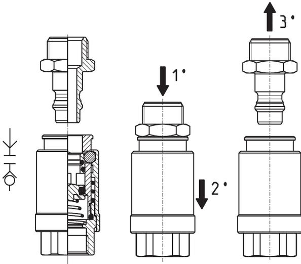
母接头的结构设计可保证接头连接时不发生意外的脱落。只有当用力按下公接头（如图示 1）和母接头螺母（如图示 2），母接头才会将公接头脱开（如图示 3）。
