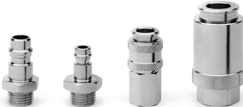
**5000L 和 5000LT 系列快速管接头**设计用来连接水路、气路或油路，应用于塑料模具或压铸模中。该系列接头由不锈钢和黄铜构成，具有水密封的结构，最高可承受 12 bar 的压力，采用氟橡胶密封胶，可耐 140°C 的高温。
