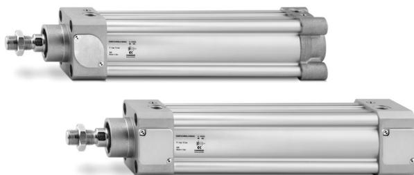
Die Zylinder sind mit einer mechanischen Endlagenverriegelung ausgestattet. Diese gewährleistet einen sicheren Halt der Kolbenstange sowohl in der vollständig ein- als auch ausgefahrenen Position. Die Verriegelung wird automatisch aktiviert und gelöst, ohne dass eine externe Betätigung erforderlich ist. Die Serie 63 entspricht der ISO Norm 15552.
