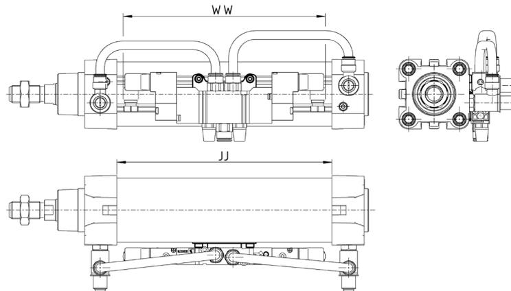
S'assurer que la dimension WW du distributeur à monter est inférieur à la dimension JJ du vérin.
