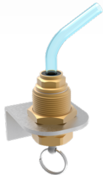
Beispiel 4: Mod. D2593 Schottadapter in Kombination mit einem Ablassventil und einem geraden Einschrauber zur dezentralen Realisierung einer Kondensatablassstelle
