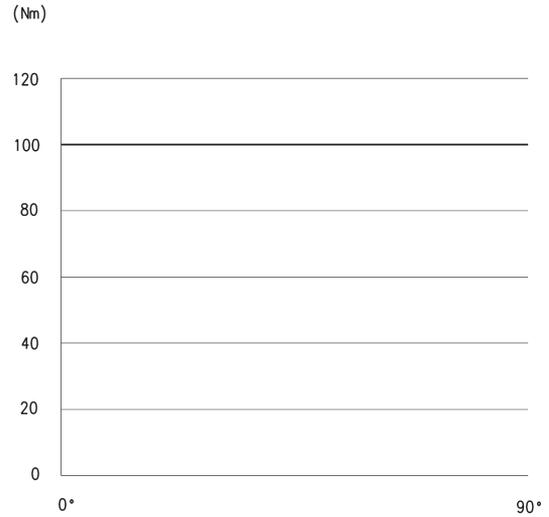
Le diagramme ci-dessus montre le couple ( Nm ) généré par un actionneur double effet Série ARP lors d'un mouvement d'ouverture. Cette action commence à 0° et finie à 90°. L'une des caractéristiques ( avantage ) de la technologie pignon/crémaillère est de développer un couple constant tout au long du mouvement. Voir aussi TABLEAU DES COUPLES sur le page suivantes
