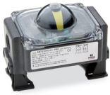
Mod. SIP: Version ATEX avec protection Ex II 2 G/D EEx ia IIC T6 pour zones 1, 2, 21 et 22.
