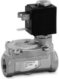
膜片式电磁阀采用先导结构，通过压差实现膜片的控制，因而能提供较大的流量，但无法实现零压工作。标准产品的膜片材质为丁腈橡胶。可按要求提供氟橡胶或三元乙丙橡胶材质的膜片。接口 G3/8 - G2。
