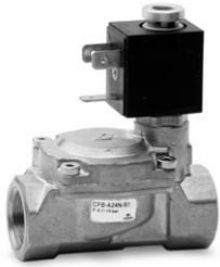
膜片式电磁阀采用先导结构，通过压差实现膜片的控制，因而能提供较大的流量，但无法实现零压工作。标准产品的膜片材质为丁腈橡胶，可按要求提供氟橡胶或三元乙丙橡胶材质的膜片。接口 G3/8 - G2。
