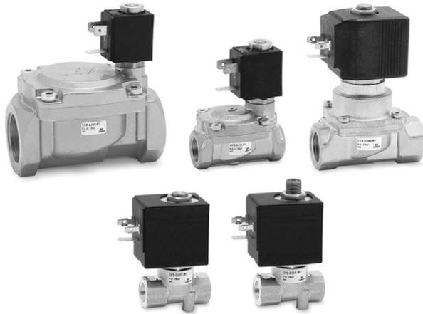
**CFB 系列电磁阀**用于流体介质, 可提供二位二通、二位三通两种机能, 常开 (NO) 或常闭 (NC)。CFB 系列有三种形式: 直动式、膜片式和混合式。每种形式均提供多种公称直径和螺纹接口, 以满足不同流量和工作压力的要求。也可按要求提供其他特殊的结构: 如防水锤结构等。
