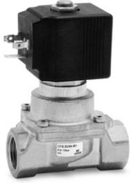
混合式电磁阀的膜片与阀内部动铁芯直接相连，可以提供较大的流量和实现零压工作（请咨询本公司销售工程师）。标准产品的膜片材质为氟橡胶。接口 G3/8 - G1。
