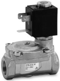
Le pilote de ces électrovannes à commande indirecte contrôle la position de la membrane grâce à la pression différentielle. Ces électrovannes sont particulièrement recommandées pour le contrôle de fluides avec grands débits et requièrent des pressions peu importantes.
