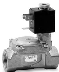
Le pilote de ces électrovannes à commande indirecte contrôle la position de la membrane grâce à la pression différentielle. Ces électrovannes sont particulièrement recommandées pour le contrôle de fluides avec grands débits et requièrent des pressions peu importantes.
