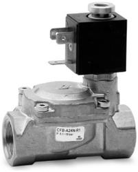
Queste elettrovalvole ad azionamento indiretto, nelle quali l'elettropilota controlla la posizione della membrana attraverso un differenziale di pressione, sono particolarmente indicate per controllare elevate portate di fluido e richiedono pressioni minime di esercizio per l'azionamento. Gli attacchi sono da G3/8 a G2. La membrana è fornita standard in NBR. A richiesta può essere fornita in FKM o EPDM.
