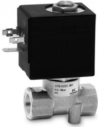
Il comando di tipo diretto di queste elettrovalvole permette l'azionamento con pressioni di esercizio uguali a zero. Gli attacchi sono da G1/8 a G1/2.
