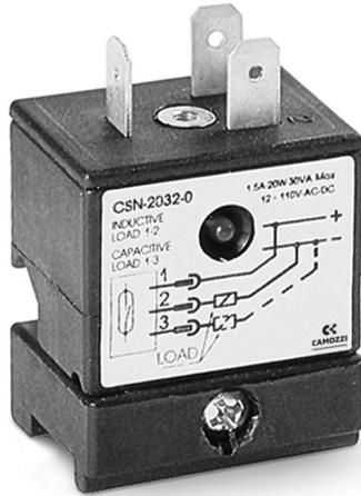
**CSN 系列磁性接近开关**由一个带电子保护电路的舌簧开关和一个包含有红色发光二极管 (LED) 的可见触点型指示器所组成，封装于绝缘密封外壳内。磁性接近开关可通过两个固定螺钉直接安装于气缸的拉杆上，确保在气缸轴向的固定；并可通过第三个螺钉固定防旋转。三个接线端子分别以数字 1、2 和 3 指示，可按图所示进行连接。
