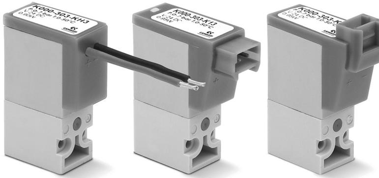
Die direktgesteuerten Sitzventile Serie K können auf Einzel- oder Reihengrundplatten montiert werden. Eine gemischte Montage von NO- und NC-Ventilen ist möglich - bei der NO-Version ist eine Adapterplatte notwendig. Handhilfsbetätigung nur für Version 3/2-Wege verfügbar.
