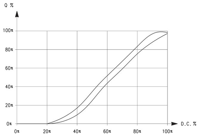
**DURCHFLUSSDIAGRAMM - Baubreite 16 mm**
