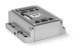
DRCS 系列步进电机驱动器采用紧凑型设计,一种规格,并为康茂胜小型和中型的步进电机进行了特别配置优化。驱动器可提供步进电机的两相控制和微步进给,可以计算步进电机的共振频率并对其进行优化驱动。微步进给技术(最高可达1/16步)可使电机近似以正弦电流驱动,从而显著减少电机本身的自然共振。驱动器可支持8位输入信号,从而可实现256条指令,方便对电机进行定位、速度、加速或减速的定义。
