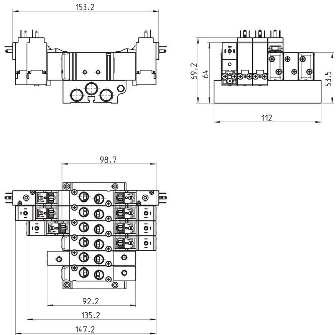
**Embases pour distributeurs avec sorties sur le corps - Taille 19**
