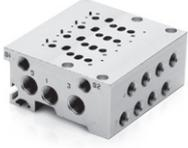
此类型气路板带有公共进气口 1 和公共排气口 3 和 5（见下图中 G2 尺寸），另有两个公用的先导排气口 82 和 84（见下图 G3 尺寸）。
