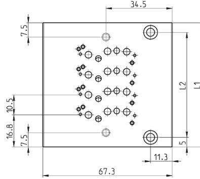
注：随气路板配套供应密封件和固定螺钉。
