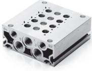
此类型气路板带有公共进气口 1 和公共排气口 3 和 5（见下图中 G1 尺寸），另有两个公用的先导排气口 82 和 84（见下图 G2 尺寸）。
