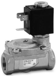
Queste elettrovalvole ad azionamento indiretto, nelle quali l'elettropilota controlla la posizione della membrana attraverso un differenziale di pressione, sono particolarmente indicate per controllare elevate portate di fluido e richiedono pressioni minime di esercizio per l'azionamento. Gli attacchi sono da G3/8 a G2. La membrana è fornita standard in NBR. A richiesta può essere fornita in FKM o EPDM.
