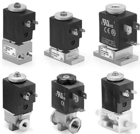
Le elettrovalvole proporzionali ad azionamento diretto 2/2 vie NC, con orifizi da 0.8 a 2.4 mm, possono essere utilizzate dove è richiesto un controllo della portata ad anello aperto, in ambito di miscelazione di gas, controllo di flussi liberi o soffi e per il controllo dello svuotamento di camere per mezzo del vuoto.
