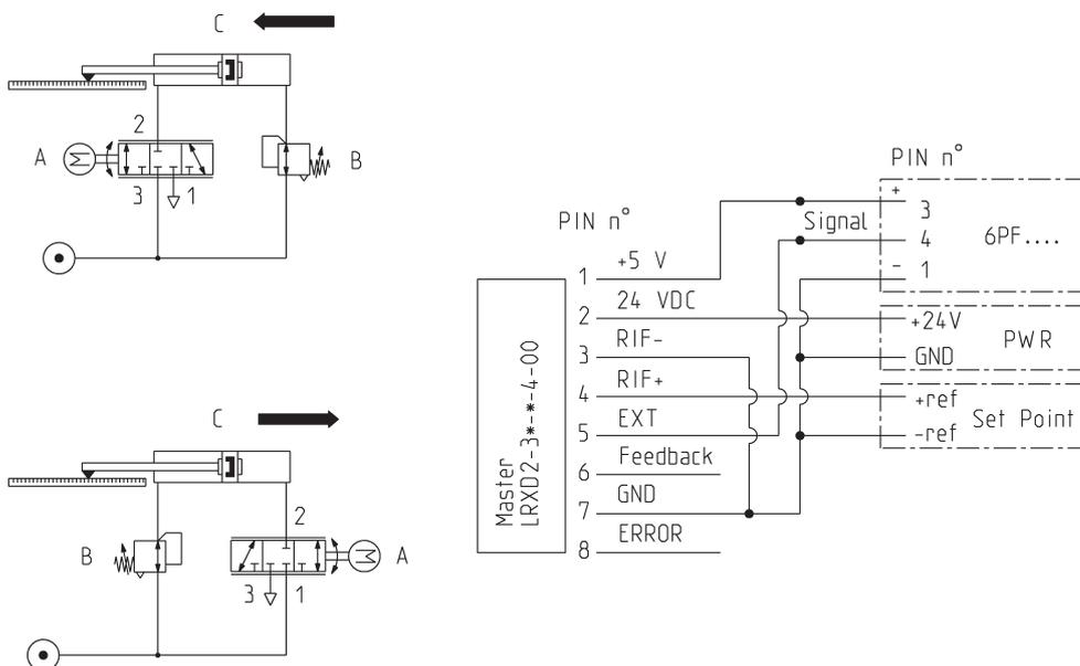
**SERIE LRPD2 - SCHEMA PNEUMATICO PER L'INSTALLAZIONE**
