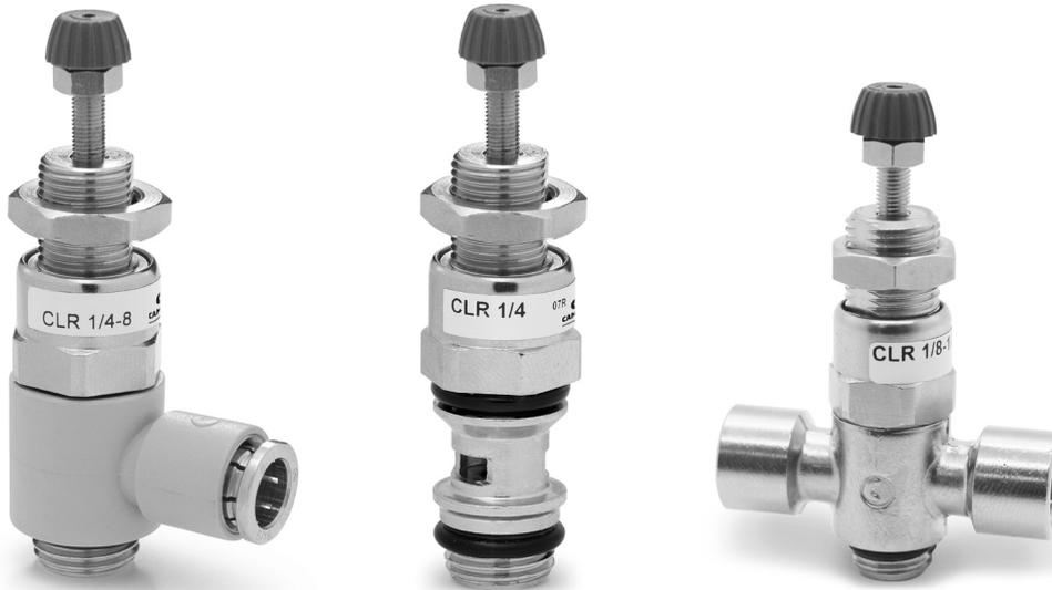
I regolatori di pressione miniaturizzati della serie CLR sono disponibili con attacchi da G1/8 e G1/4. Il tipo costruttivo è a pistone, funzione VS (valvola di by-pass) con o senza relieving. Il corpo è in ottone mentre il raccordo di connessione è un orientabile in tecnopolimero che garantisce la massima leggerezza. Possono essere forniti senza o completi di orientabile e possono essere montati a pannello.
