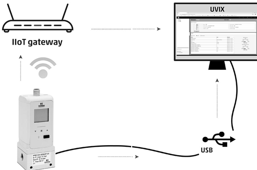
Tramite questa funzione, si ha anche un controllo sulla temperatura interna e sulle ore effettive lavorate dal regolatore. Tutte queste segnalazioni possono essere lette tramite il software di supervisione "UVIX", scaricabile gratuitamente dal sito internet Camozzi sezione prodotti.
