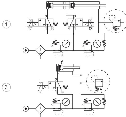
**SCHEMA DI FUNZIONAMENTO 1:** scarico della sovrappressione in una camera di un cilindro o in un serbatoio quando viene superato il valore impostato.
