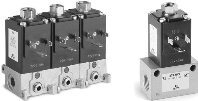
Die direktgesteuerten Elektromagnetventile Serie 6 sind erhältlich in 2/2-, 3/2-Wegeausführung, NC und NO. Konstruktionsbedingt ist bei diesen Sitzventilen keine Schmierung notwendig.
