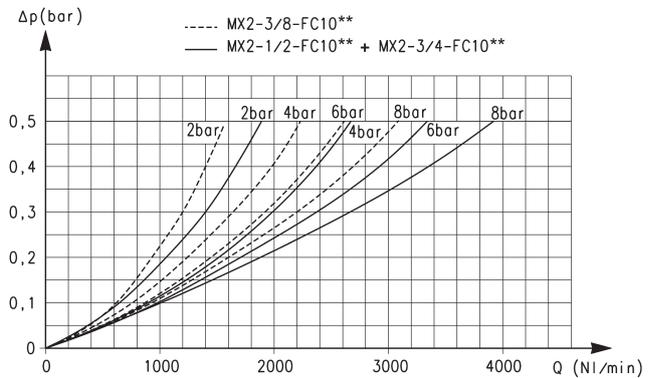
Diagrammes des débits pour un élément filtrant = 1 μm
