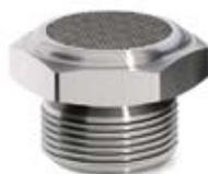
I silenziatori sono elementi indispensabili per eliminare o attenuare il caratteristico rumore dell'aria compressa durante le fasi di scarico. Il loro collegamento in atmosfera naturale è sempre situato sugli scarichi delle valvole a 3/2, 5/2 o 5/3 vie. In fase di manutenzione si consiglia di sgrassare i silenziatori con benzina o petrolio avendo cura di soffiare con aria compressa nel senso opposto all' utilizzazione.
