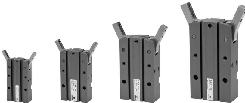
La serie CGSY è stata progettata per garantire performance costanti nel tempo, anche in tutte quelle applicazioni che richiedono elevati livelli di produttività. L'apertura a 180° permette di operare con ampie zone di lavoro, ottimizzando i movimenti di manipolazione dei manufatti e rendendo questa pinza particolarmente adatta in applicazioni come il soffiaggio di bottiglie in PET o il riempimento in ambito alimentare o chimico.
