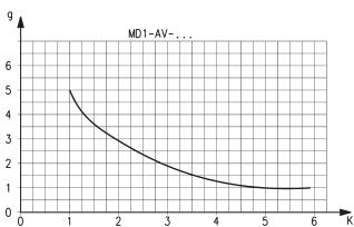
Tempi di pressurizzazione rispetto al n° di giri della vite di regolazione, con volume serbatoio di 5 Litri. A = 5 giri; B = 4 giri; C = 3 giri; D = 2 giri; E = 1 giro. Individuando la costante k sul grafico, si ottiene il n° di giri da effettuare sulla vite di regolazione per ottenere il tempo di riempimento a 6 bar. Al variare della pressione può esserci uno scostamento  $\pm$  20%. K = t/V dove: V = volume dell'impianto a valle in litri e t = tempo di riempimento desiderato in secondi.
