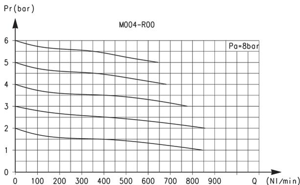
Diagramma di portata per modello: M004-R00
