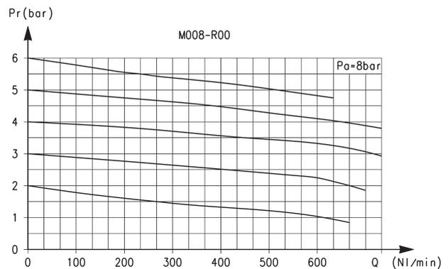
Diagramma di portata per modello: M008-R00
