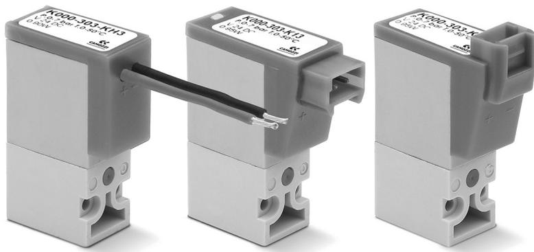
**K 系列直动式微型电磁阀**可提供二位二通和二位三通两种机能, 二位二通可提供常闭类型; 二位三通可提供常闭、常开两种类型。电磁阀可安装于单阀座或气路板上使用, 二位二通和二位三通使用的单阀座或气路板完全通用。
