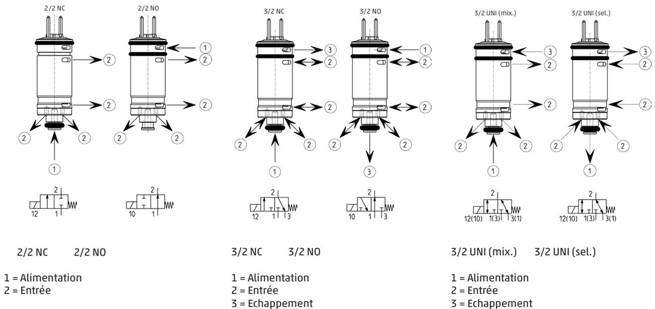
La version 3/2 UNI peut également être utilisée pour les fonctions 3/2 NC ou 3/2 NO.
