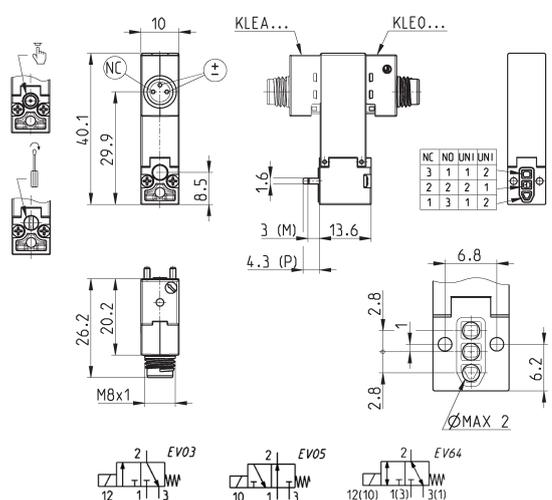
\* gewünschten VENTILKÖRPER, HANDHILFSBETÄTIGUNG, SPANNUNG, BEFESTIGUNG ergänzen (siehe Modellbezeichnung)
