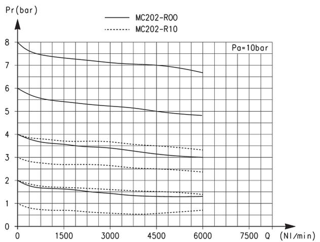
Durchflussdiagramm Modelle MC202-R00 und MC202-R10
