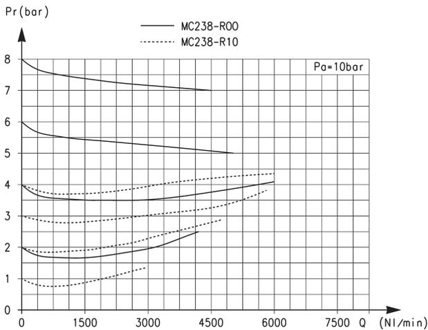
Durchflussdiagramm Modelle MC238-R00 und MC238-R10
