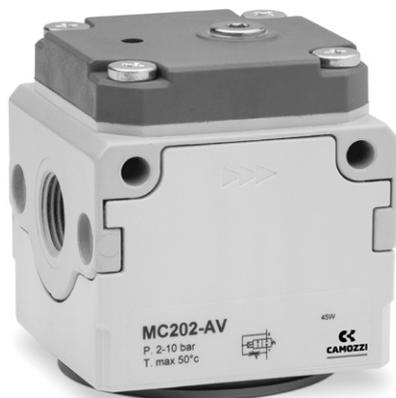
**MC 系列软启动阀**可以使气动系统逐步加压至所需要的压力，以防止气动系统在通入压缩空气的一瞬间，造成人员或设备的伤害。当向气动系统输入压缩空气时，在压力逐步升高至系统设定压力的 50% 后，系统压力在一个非常短的时间内升至设定压力的 100%。
