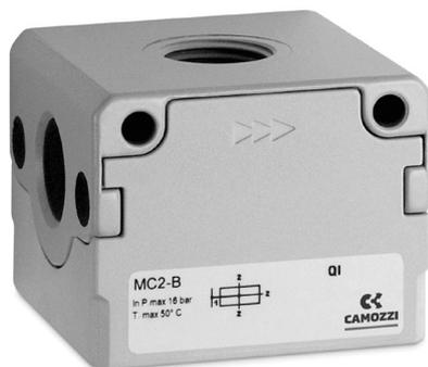
Der Verteilerblock wird zwischen den Regler und Öler gesetzt, um einen zusätzlichen Abgang für ölfreie Luft zu erhalten. Wenn der Verteilerblock am Ende montiert wird, müssen zusätzlich Endplatten (Kit A) verwendet werden.
