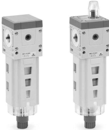
Este filtro fino de separador de aceite remueve los sólidos con dimensiones desde 0.1 hasta 5 µm y vapores de aceite con una concentración desde 0.01 hasta 0.1 mg/m³. Para un correcto funcionamiento ellos requieren un pre-filtro. Dadas las características de este filtro, es recomendable reemplazar el elemento filtrante al menos cada 12 meses o 8000 horas de trabajo.
