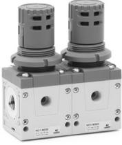
Grâce à la version Batterie, il est possible de réaliser une batterie de régulateurs alimentée par une pression d'entrée unique. Chaque régulateur peut-être réglé à une pression différente ( inférieure à celle d'alimentation ). Chaque régulateur est doté d'une sortie à l'avant et à l'arrière.
