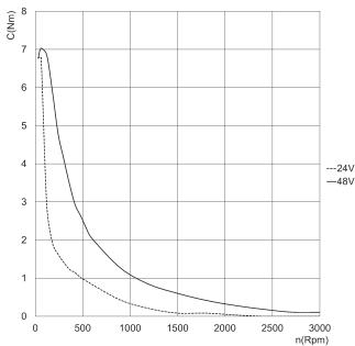
Nema 24 电机 型号 MTS-24-18-250-0-0-S-C 型号 MTS-24-18-250-0-0-E-C 型号 MTS-24-18-250-0-F-E-C 型号 MTS-24-18-250-0-0-S-CP
