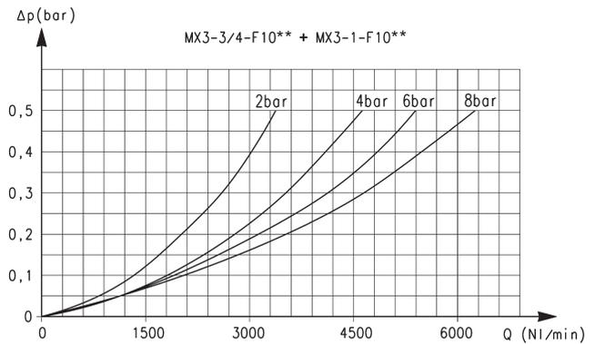
Diagrammes des débits pour un élément filtrant = 5 µm
