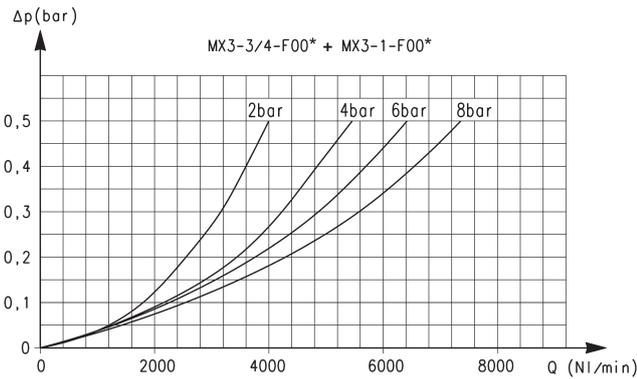
Diagrammes des débits pour un élément filtrant = 25 µm
