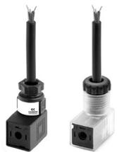
Le circuit redresseur du connecteur Mod. 125-800 permet une utilisation de l'électrovanne avec une tension AC de même valeur, même si la tension indiquée sur l'électrovanne est en DC.
