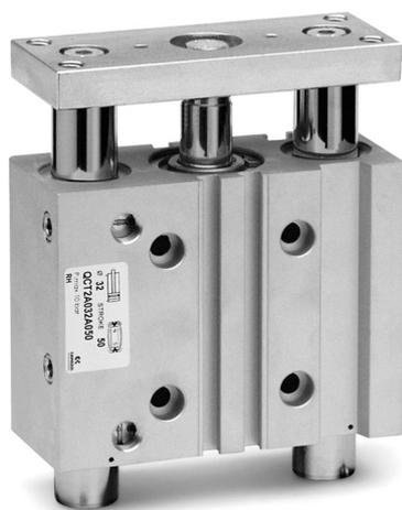
Die kompakten Führungseinheiten Serie QCT + QCB sind für beengte Einbauverhältnisse und verdrehgesicherte Einsatzfälle konzipiert worden. Es stehen zwei Versionen zur Verfügung, mit Führungsbuchsen sowie mit Kugelführungen. Die Ausführung mit einfachen Buchsen eignet sich für hohe Querkräfte. Diese Belastungsart kann doppelt so hoch wie bei einem konventionellen Pneumatikzylinder sein.
